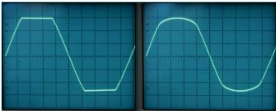
Anhand der beiden Darstellungen ist die Wirkungsweise der Overkiller-Funktion zu erkennen. Im Test schickten wir einen Sinus-Ton durch das Orpheus und fuhren das Signal in die Übersteuerung. Das Oszilloskop zeigte uns, was passiert: Links ist die verzerrte Schwingung zu erkennen, rechts die durch den Limiter abgerundet.
