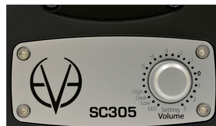
Alle EVE Audio-Monitore haben digitale Endstufen und einen DSP, der alle Einstellungen und Filterungen übernimmt. Alle Einstellungen sind bequem über den Drehregler/Druckgeber auf der Front vornehmbar.
